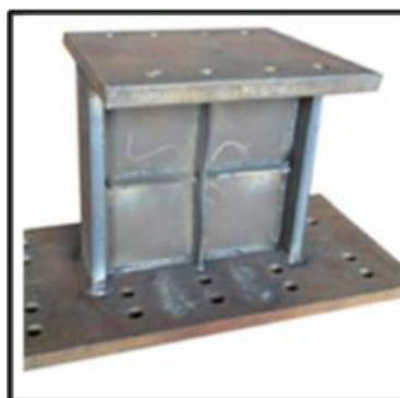
Figura 3.29: Reforços nos dissipadores do tipo SPD. Adaptado de (Chen et al., 2013)
