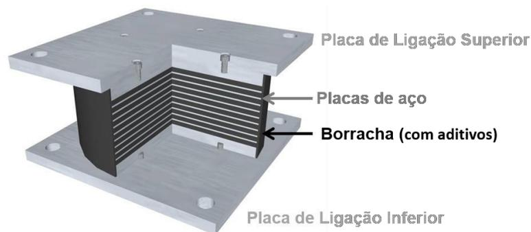
Figura 2.3: Constituição de um apoio LDRB e HDRB. Adaptado de (Amaral, 2013)
