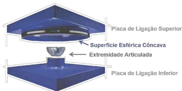
Figura 2.5: Constituição de um apoio FPB. Adaptado de (Amaral, 2013)
